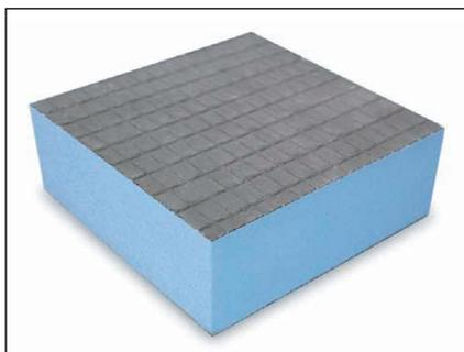
IT - Il kit di coibentazione Gruppo Geromin possiede un nucleo blu di schiuma rigida di polistirene estruso senza HCFC. La schiuma rigida è armata su entrambi i lati con tessuto in fibra di vetro, nonché ricoperta su entrambi i lati con malta arricchita con resine sintetiche. Il pannello di spessore 30 mm è la base ideale per la posa di piastrelle. Può essere utilizzato su qualsiasi sottofondo, essendo impermeabile all'acqua e termoisolante. Dimensioni pannelli 1250x600 mm.
